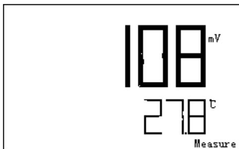
被测溶液 mV 测量显示示意图 (图 13)
