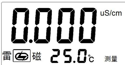
在测量状态下，按“温度”键设置当前的温度值；按“电极常数”和“常数调节”键进行电极常数的设置，简要的操作流程见下图：
