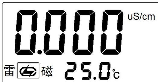
按“温度△”或“温度▽”键调节显示值，使温度显示为被测溶液的温度，按“确认”键，即完成当前温度的设置；按“测量”键放弃设置，返回测量状态。
